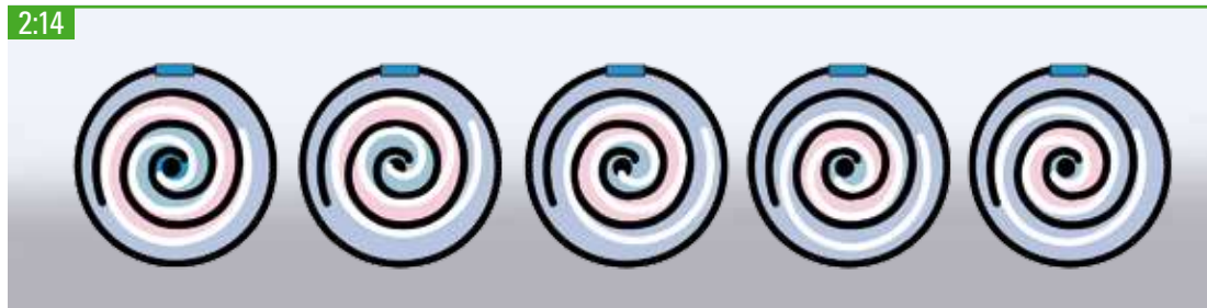
Principio di compressione di un compressore scroll.
