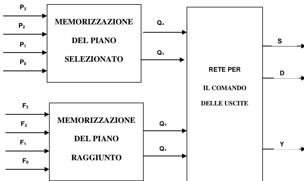
Fig. 47 Schema a blocchi del sistema per il controllo di un ascensore a quattro piani.
