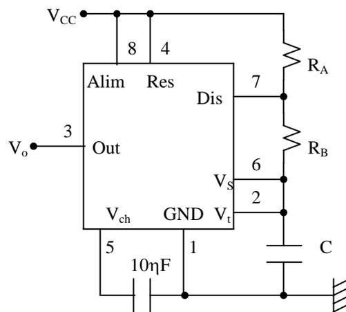
Supponendo il condensatore C inizialmente scarico, al momento dell'alimentazione del circuito, gli ingressi di trigger e di soglia in tale istante vengono cortocircuitati a massa dal condensatore (differenza di potenziale ai suoi capi nulla, i due terminali sono equipotenziali).
