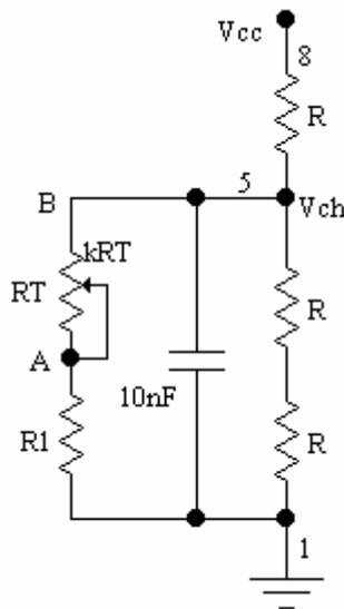
Se si aggiunge in serie alla resistenza sul pin 5 un trimmer, si ha la possibilità di far variare la tensione  $V_C$ , che determina la fine dell'impulso, tra un valore minimo e un valore massimo.
