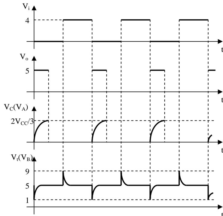
È stato necessario sostituire la capacità  $C_i$  di 10pF con una da 1nF in quanto la durata dell'impulso era insufficiente a innescare la commutazione dell'uscita.
