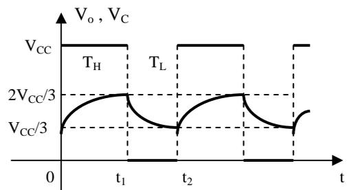
Quando l'uscita è alta il transistor di scarica è interdetto, il diodo è in conduzione e cortocircuita la resistenza  $(1-k)R_P + R_B$ . Il condensatore si carica, partendo da  $V_{CC}/3$  verso  $V_{CC}$ , attraverso la resistenza  $kR_P + R_A$ , con equazione
