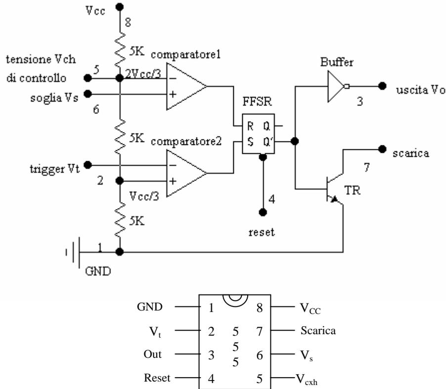
Il partitore di tensione resistivo R-R-R fornisce le tensioni di riferimento ai comparatori di trigger ( $V_{CC}/3$ ) e di soglia ( $2V_{CC}/3$ ). Se si inserisce tra il pin 5 ( $V_{ch}$ ) e massa una resistenza si ottiene una tensione di riferimento nel comparatore di soglia minore di  $2V_{CC}/3$  (e una tensione di riferimento nel comparatore di trigger minore di  $V_{CC}/3$ ).
