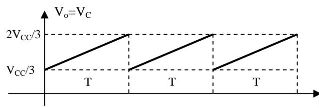
Il condensatore si carica a corrente costante attraverso il transistor TR2 e si scarica quasi istantaneamente quando, saturandosi il transistor di scarica del timer 555, attraverso il pin 7 viene cortocircuitato a massa. La carica della capacità inizia dal valore  $V_{CC}/3$  e termina quando la sua tensione raggiunge il valore  $2V_{CC}/3$ .
