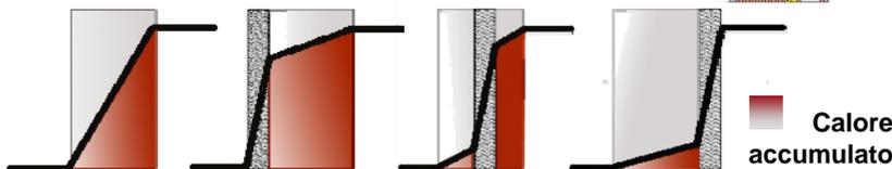
Prestazione inerziale della muratura in relazione alla disposizione dello strato isolante
