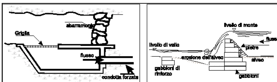
Figura 5.8: Configurazioni di traverse
