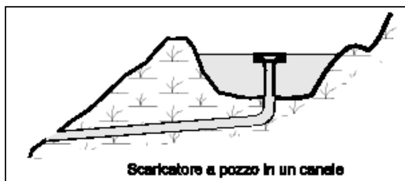
Figura 5.13: Sezione schematica di uno sfioratore a calice
