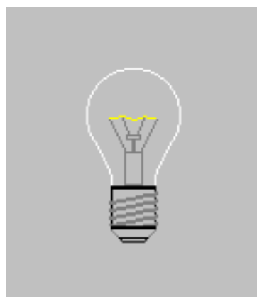
Figura 2 - Come funzionerebbe una lampada se la corrente alternata di rete avesse una frequenza troppo bassa
