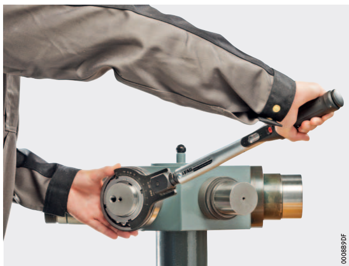
Figura 11 Montaggio mediante chiave a doppio gancio
