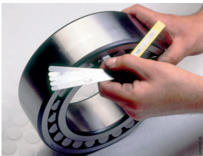
Figura 7 Misurazione del gioco radiale con spessimetro
