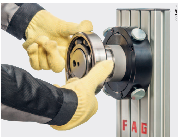
Figura 14 Montaggio in sede del cuscinetto riscaldato
