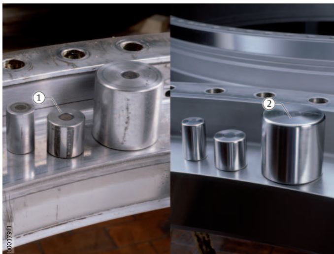
Figura 3 Rulli e pista di rotolamento dei cuscinetti volventi prima e dopo la rigenerazione
