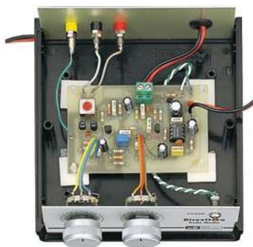
Fig.362 Per fissare la basetta del ricevitore all'interno del mobile, dovrete inserire nei quattro fori presenti nel circuito stampato i perni dei distanziatori plastici che troverete inclusi nel kit.
