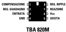
Fig.353 Connessioni dei terminali dei diodi varicap BB.112, del fet J.310 e della Media Frequenza MF1 viste da sotto. Le connessioni del solo integrato TBA.820/M sono viste da sopra. Ricordate che il terminale più lungo del diodo DL1 è l'A ed il più corto il K.
