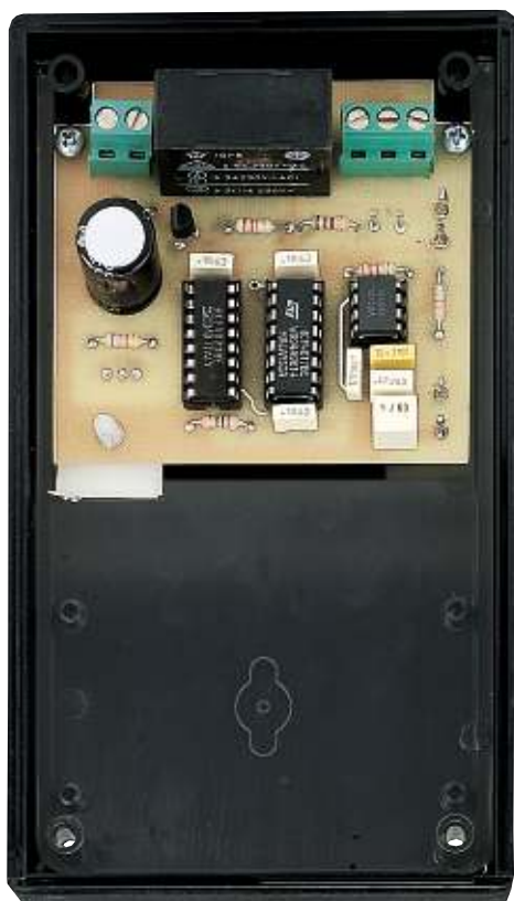
Fig.490 Fissate il circuito stampato sulla base del mobile per mezzo di due viti autofilettanti e di un distanziatore plastico provvisto di base autoadesiva.
