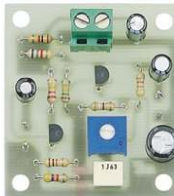
Fig.459 Sopra, lo schema pratico di montaggio del kit LX.5012 e sotto la foto del preamplificatore a guadagno variabile.
