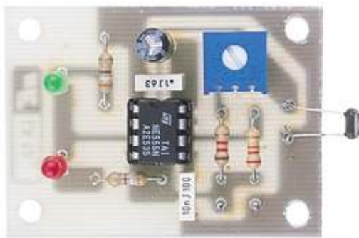
Fig.130 Come si presenta a montaggio ultimato il Rivelatore Crepuscolare.
