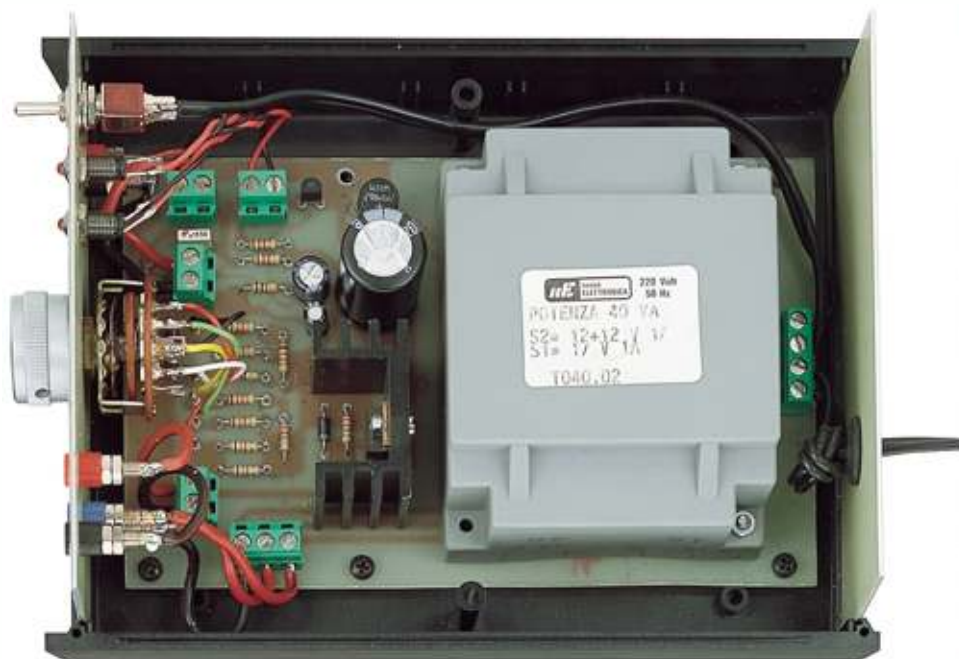
Fig.200 La scheda montata andrà poi fissata all'interno del suo mobile plastico. Sul pannello frontale fisserete il commutatore S2, le bocche d'uscita e le gemme cromate contenenti i diodi led. Per le connessioni al commutatore S2 potrete fare riferimento alla fig.204 e per fissare le bocche d'uscita sul pannello al disegno riportato in fig.206.
