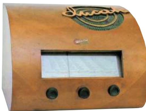
Fig.373 Verso il 1939-1940 in ogni ricevitore venne inserita una "scala parlante" con inciso il nome di tutte le emittenti operanti sulle OM. In questa foto, una vecchia supereterodina costruita dalla Ducati di Bologna negli anni 1940-1946.
