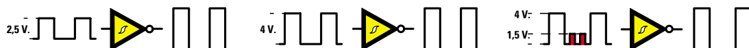
Fig.589 Una porta Inverter Triggerata riconosce come Livello logico 1 solo quei segnali che superano un livello di 2 volt, quindi se sugli ingressi giungono degli impulsi di disturbo che non superano una tensione di 2 volt, non vengono rilevati.
