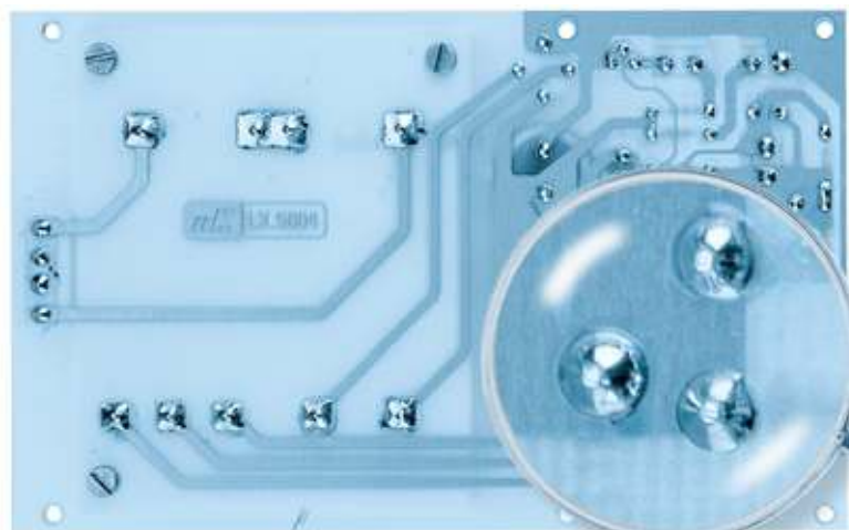
Fig.201 In questa foto potete vedere come debbono presentarsi tutte le stagnature sulle piste in rame del circuito stampato.
