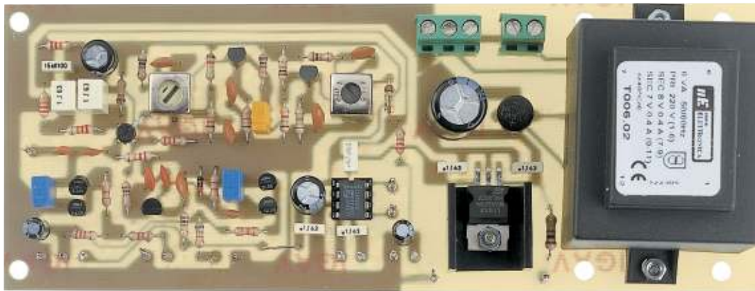
Fig.378 Ecco come si presenterà il circuito stampato quando avrete montato tutti i componenti. Sul circuito stampato che vi forniremo, troverete riprodotto il disegno serigrafico di ogni componente e la relativa sigla, quindi sarà impossibile sbagliare.
