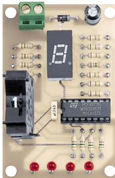
Fig.629 Ecco come si presenterà il circuito dopo aver montato tutti i componenti.
