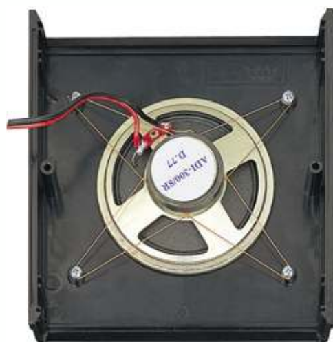
Fig.361 Per fissare l'altoparlante sul coperchio del mobile dovrete avvitare nei supporti plastici delle viti autofilettanti e poi avvolgete su queste due spezzoni di filo di rame disponendoli a X.
