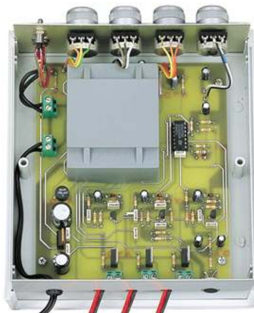
Fig.565 Dopo aver collegato i potenziometri al pannello frontale, collegatene i terminali al circuito stampato come abbiamo illustrato in fig.563.
