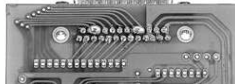
Fig.173 Sciogliendo sul terminale un eccesso di stagno è molto facile collegare insieme due terminali adiacenti. Per stagnare i terminali di un Connettore conviene usare punte molto sottili.
