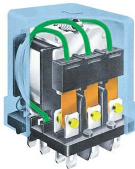
Fig.209 Il relè è un componente composto da una elettrocalamita e serve a chiudere o ad aprire dei contatti meccanici.
