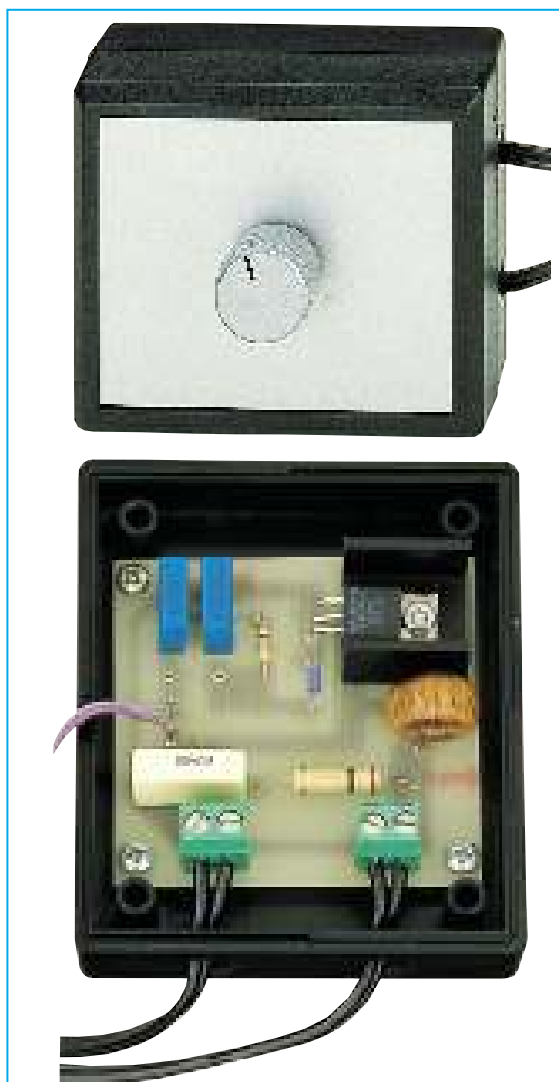
Fig.548 Il mobile del varilight chiuso, e aperto per farvi vedere come risulta fissato il circuito stampato al suo interno.
