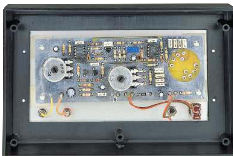
Fig.139 Il circuito LX.5032 andrà fissato all'interno del suo mobile plastico utilizzando i 4 distanziatori plastici con base autoadesiva inseriti nel kit.
