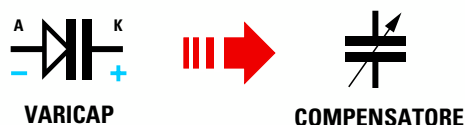
Fig.109 Sulla sinistra il simbolo grafico di un diodo varicap. Questi diodi sono dei piccoli condensatori di capacità variabile.
