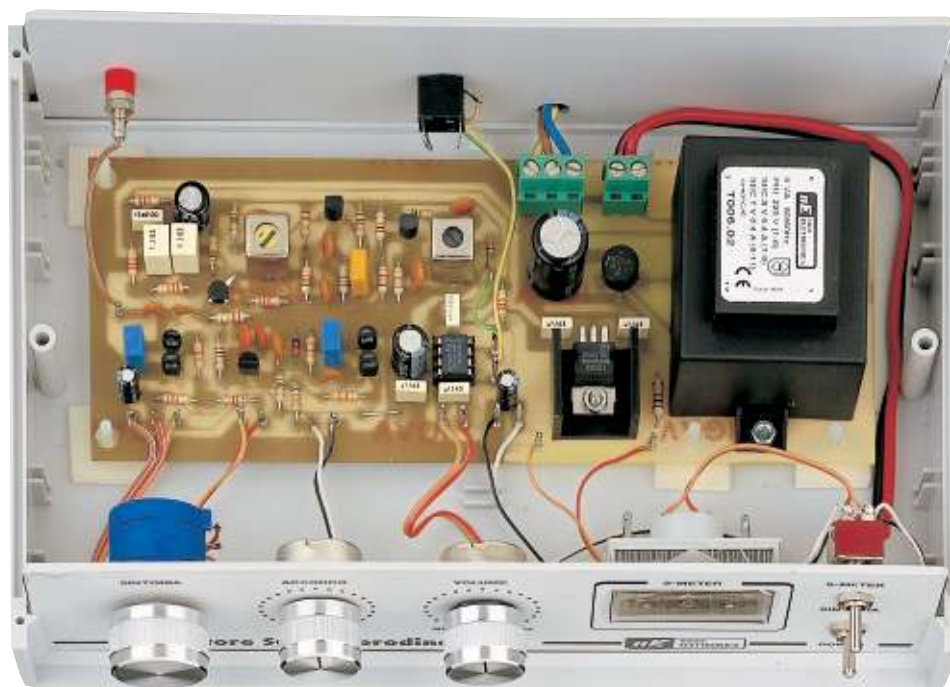
Fig.382 Il circuito stampato va fissato all'interno del mobile con dei distanziatori plastici con base autoadesiva che innesterete nei 6 fori presenti sullo stampato. Prima di fissare i potenziometri di Accordo e del Volume sul pannello frontale, dovete accorciare i loro perni per tenere le manopole il più vicino possibile al pannello.
