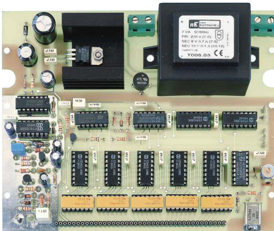
Fig.597 In questa foto potete vedere la scheda base siglata LX.5048 con sopra già montati tutti i suoi componenti. La foto della scheda display siglata LX.5048/B è riprodotta in fig.593. Facciamo presente che le foto riproducono i circuiti stampati sprovvisti del disegno serigrafico dei componenti e delle relative sigle, che invece risultano presenti in tutti i circuiti stampati che forniamo insieme al kit.
