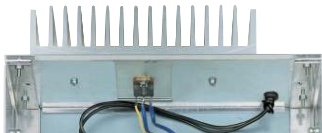
Fig.27 Il transistor TR2 andrà fissato sull'aletta di raffreddamento collocata sul pannello posteriore del mobile.
