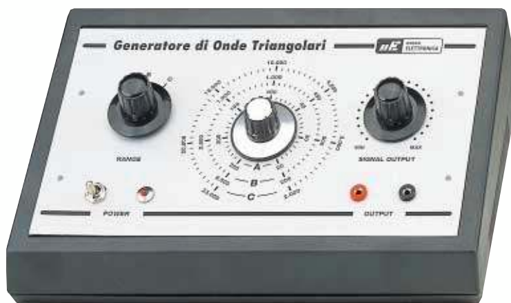
Fig.128 Foto del Generatore BF per onde triangolari da 20 Hertz fino a 20.000 Hz siglato LX.5031.
