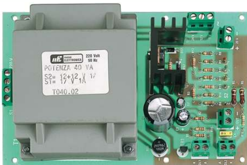
Fig.199 Dopo aver montato tutti i componenti sul circuito stampato e stagnati i loro terminali sulle piste in rame sottostanti, otterrete un montaggio simile a quello visibile in questa foto. Si noti l'aletta di raffreddamento con sopra fissato l'integrato IC1.
