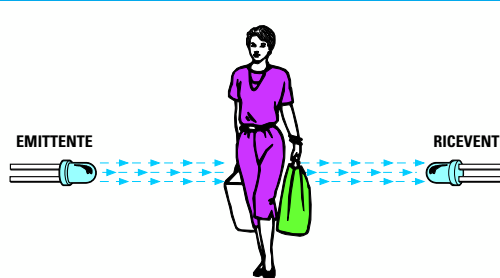
Fig.128 I fotodiodi vengono utilizzati per realizzare apriporte - antifurti - contapezzi.
