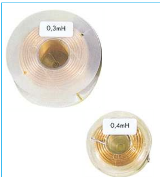
Fig.182 Le induttanze da utilizzare per i filtri Cross-Over si ottengono avvolgendo su un rochetto di plastica, non importa se tondo o quadrato, un certo numero di spire di filo di rame. Più spire avvolgerete sul rochetto più aumenterà il valore in millihenry della bobina.
