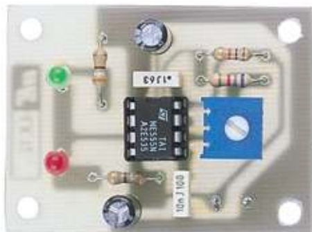
Fig.129 Come si presenta a montaggio ultimato il Lampeggiatore a due diodi led.
