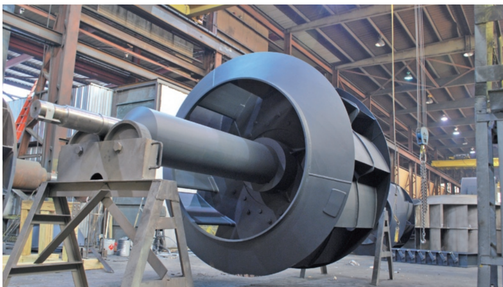
3 Girante di un ventilatore centrifugo a pale rovesce. Le dimensioni e la criticità del funzionamento costringono ad un accurato controllo in fabbrica di ogni elemento, ivi incluso il bilanciamento (Process Barron).
