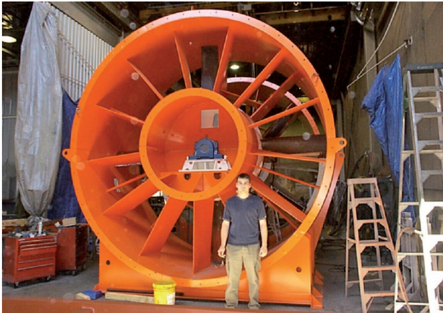
4 Come per i modelli centrifughi, anche i ventilatori assiali per impieghi industriali vengono realizzati specificamente su commessa, in modo da rispondere esattamente alle esigenze progettuali dell'impianto.
